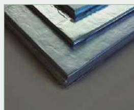
Die ultradünnen U-Vacua™-Wärmedämmplatten haben einen einzigartigen Glasfaserkern, der von einem mehrschichtigen Laminat u. a. aus Nylon, Aluminium und einer weiteren Schutzschicht umschlossen wird. Durch Senkung des Innendrucks auf 1 – 20 Pa wird das Material verdichtet und seine Wärmeleitfähigkeit minimiert.
